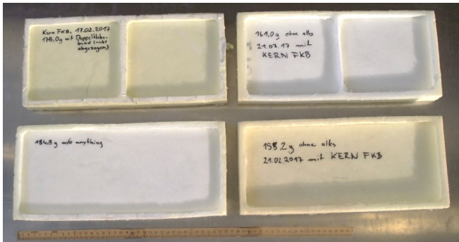
Abbildung 8: PUR-Schäume mit Vertiefungen. Links: 10 mm Tiefe; Rechts: 15 mm Tiefe.
