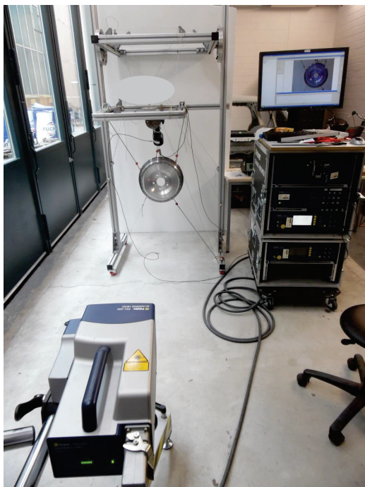
Abbildung 6: Für die Validierung der numerischen Schwingungsanalyse genutzter Versuchsaufbau
