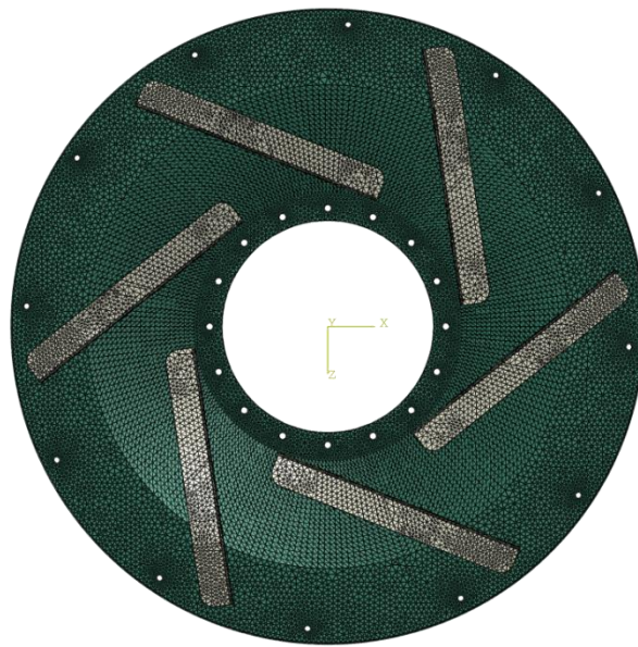
Bild 17: Diskretisiertes Modell des Rotordeckels aus Faserverbundwerkstoff
