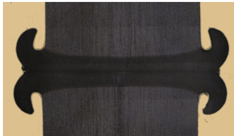
Figure 0.1: Typisches Schliffbild einer Reibschweißung
